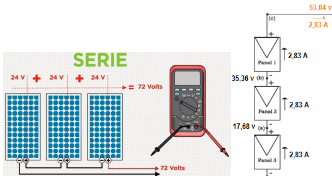
Figura 38. Diagrama de Conexión en Serie. Fuente: Fundación Carlos Slim, (2017).
