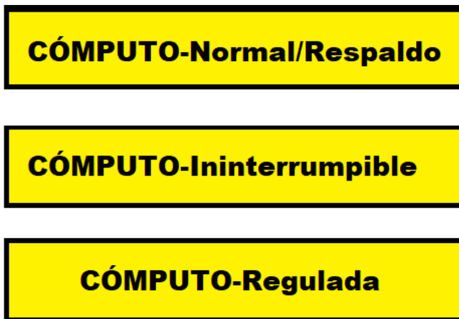
Figura 10. Identificación de Canalizaciones. Fuente: El Autor.
