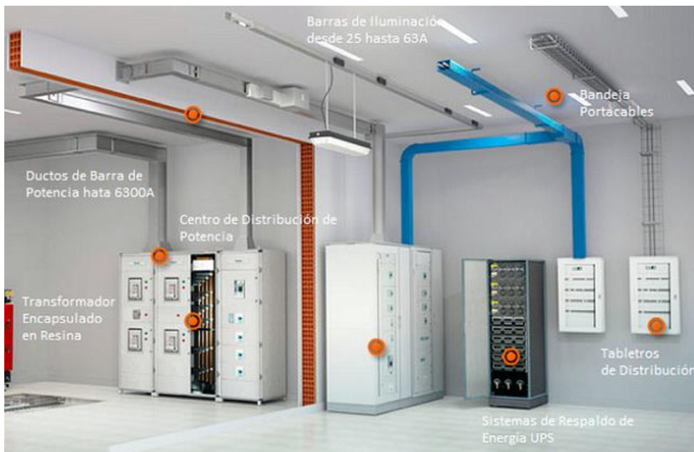
Figura 7. Ductos y Bandejas en Data Centers. Fuente: INELEC, (2019).
