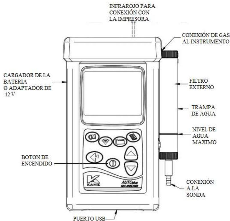
**Figura 2.10** Estructura del equipo
