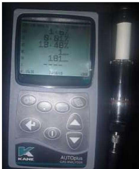
**Figura 2.9** Analizador de gases Kane AUTOplus 5-2
