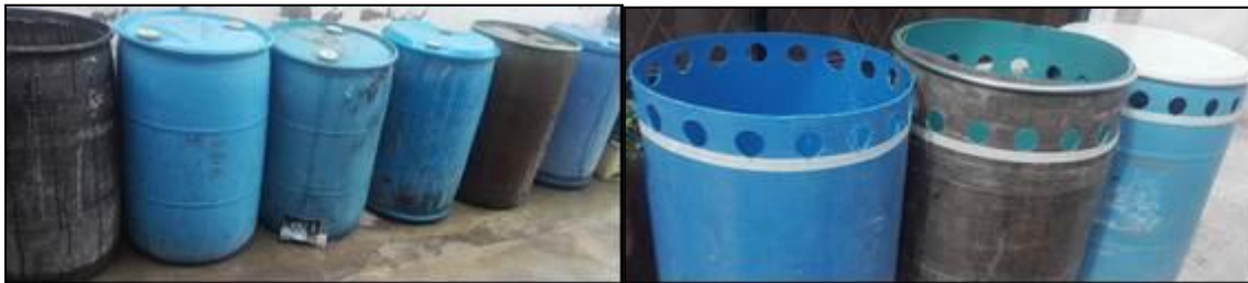
Figura 31. Hoyado de los tanques colectores de agua.
