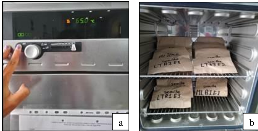
Figura 23. Secado muestras rendimiento, a) temperatura estufa b) muestras dentro de la estufa.
