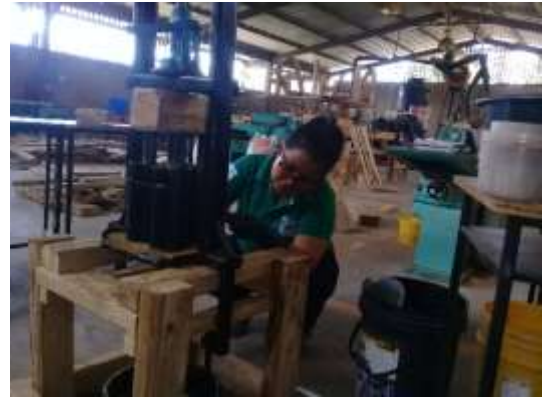
Ilustración 8. Prensado de mezcla para elaboración de briquetas.
