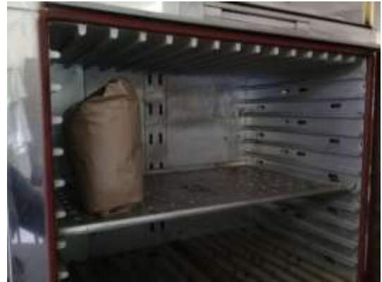
Ilustración 2. Secado de muestra previo a caracterización.
