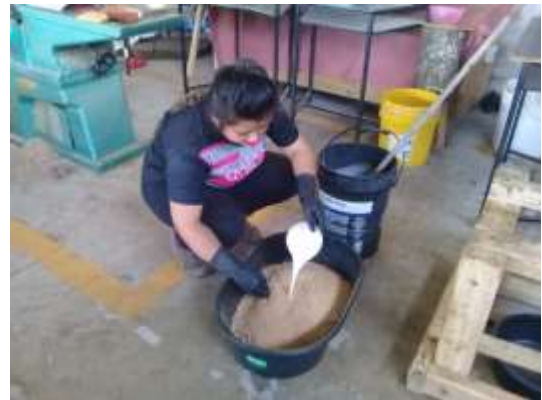
Ilustración 6. Mezcla aglutinante – material residual
