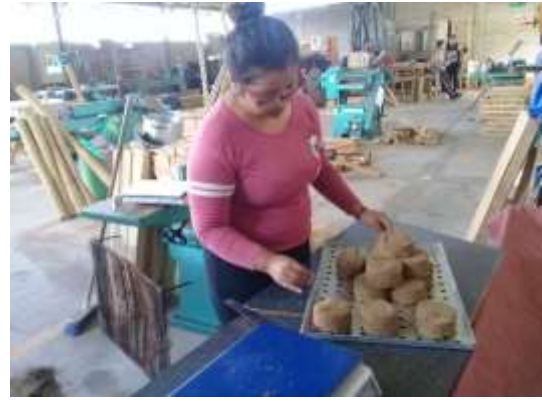
Ilustración 14. Preparación de briquetas para ensayo de combustión.
