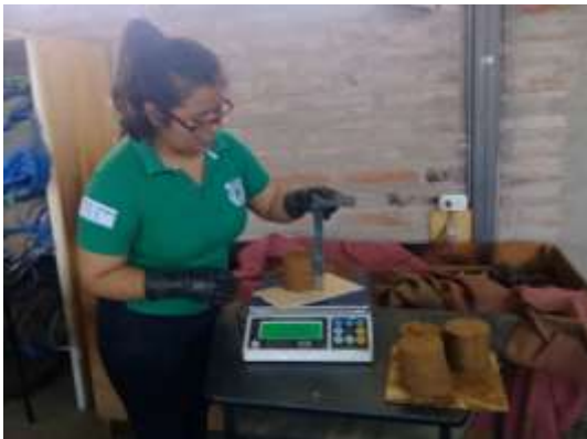
Ilustración 9. Pesado inicial de briqueta.
