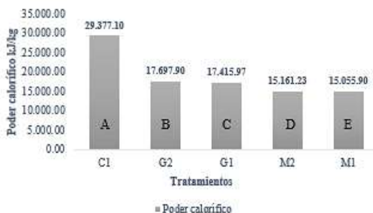
Figura 9. Prueba de Tukey para el ensayo de combustión con el calorímetro isoperibólico AC500
