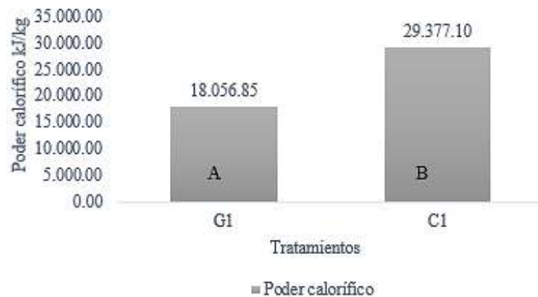
Figura 10. Poder calorífico con diferentes análisis de combustión
