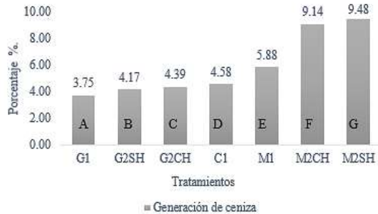
Figura 16. Porcentaje total de ceniza generada después del proceso de combustión.
