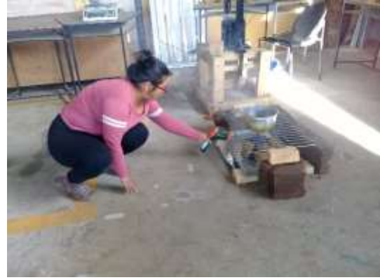
Ilustración 16. Monitoreo de temperatura del combustible.
