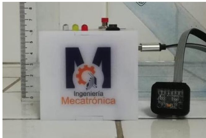
Figura 17. Dispositivo para medir el tremor en personas con EP.
