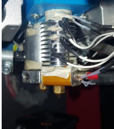
Fig. 32. Posición de los termistores en el disipador de calor. [13]
