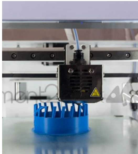
Fig. 5. Extrusor tipo Bowden. [10]
