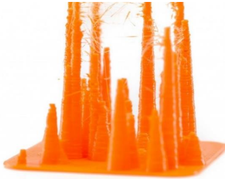
Fig. 14. Generación de hilos (Stringing). [15]
