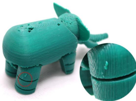
Fig. 15. Temperatura del HotEnd excesiva. [15]
