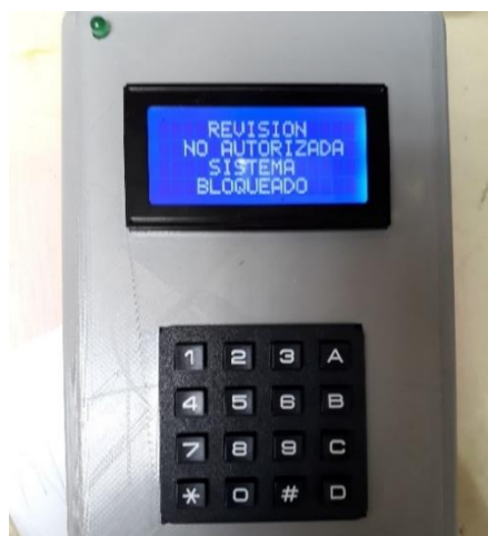
Fig. 51 Alarma del medidor al manipular sin autorización el medidor
