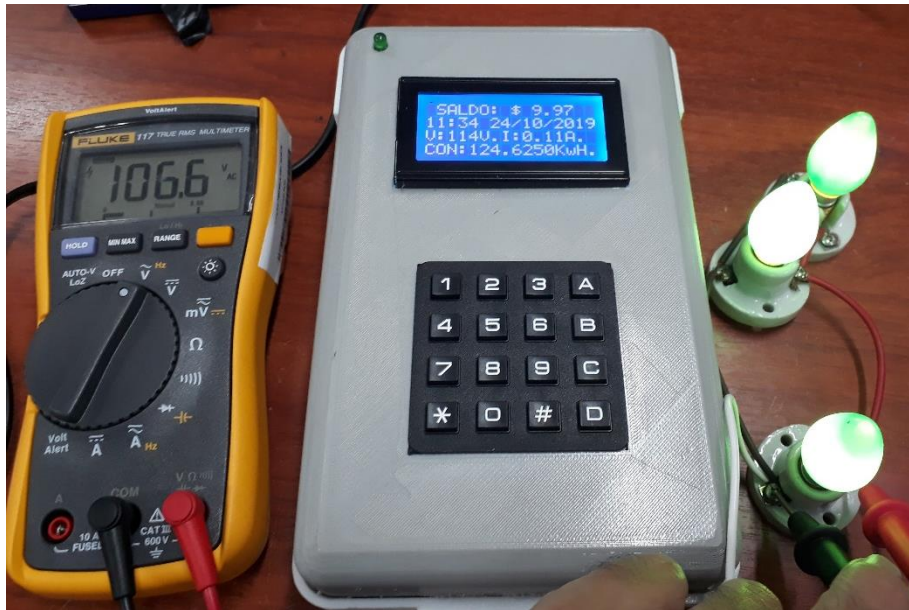
Fig. 46 Comparación de medición de voltaje del medidor y un multímetro el día 24/10/2019 a las 11:34hrs.
