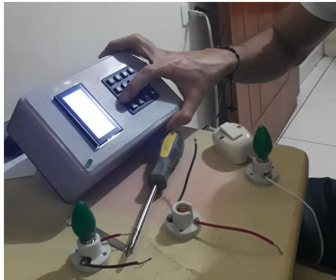
Fig. 60 Conexión de 3 luminarias hacia el medidor.
