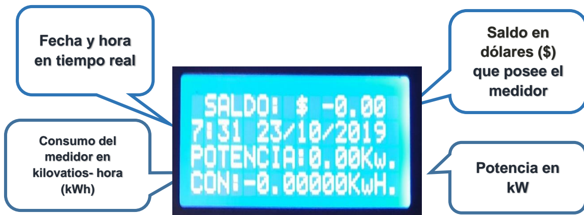
Fig. 36 Pantalla 2 del medidor
