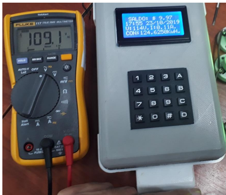
Fig. 44 Comparación de la medición de voltaje del medidor y un multímetro Fluke 117 el día 23/10/2019 a las 17:54horas.
