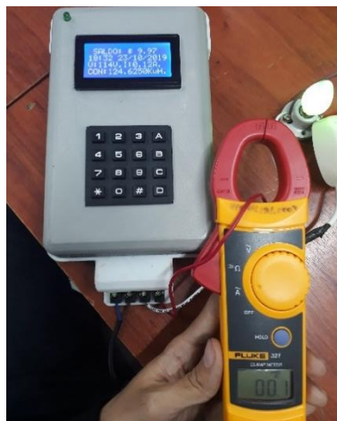
Fig. 62 Medición de corriente con una pinza amperimétrica Fluke 327.
