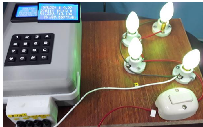
Fig. 68 Carga de 4 luminarias conectadas al medidor.
