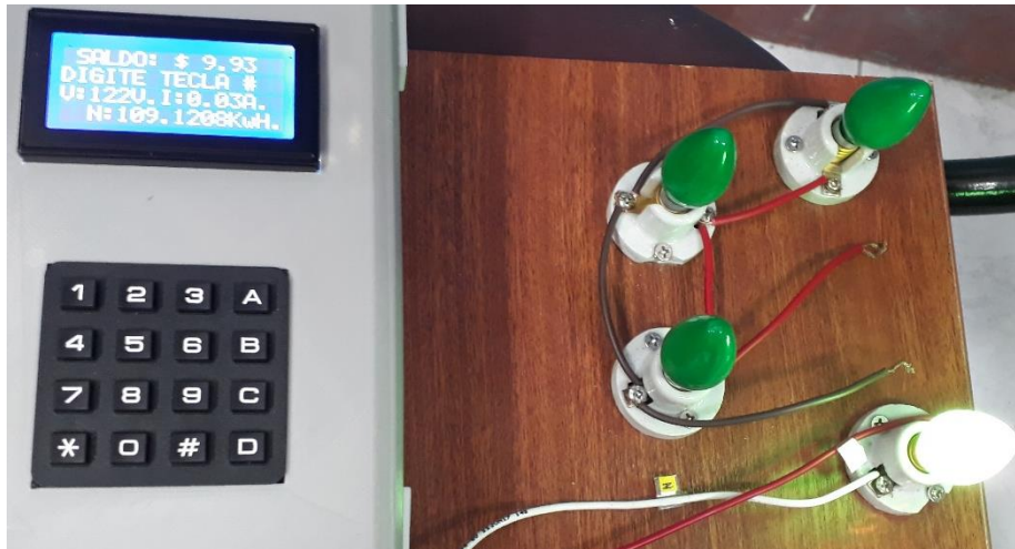
Fig. 65 Carga de 1 luminaria conectada al medidor.
