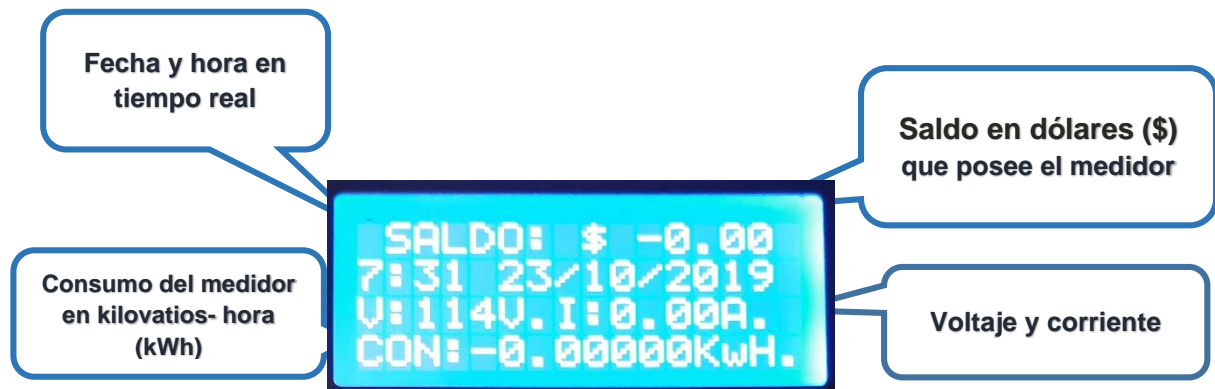
Fig. 35 Pantalla 1 del medidor
