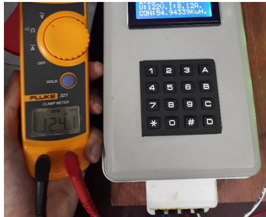
Fig. 63 Voltaje medido con una pinza amperimétrica Fluke 321
