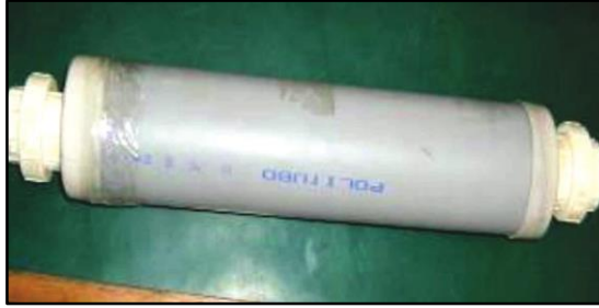
Figura. 30 Filtro de sulfuro de Hidrogeno Fuente: Recuperado de (Diaconia. 2014)
