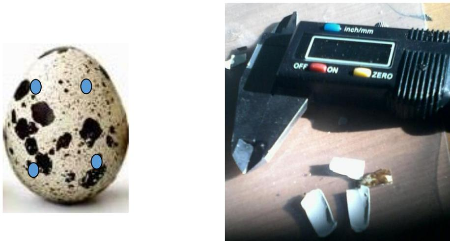
Figura 6 Secciones de muestreo y medición de grosor de cáscara de huevo con calibrador digital.
