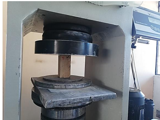
Ensayo de compresión paralela a la fibra
