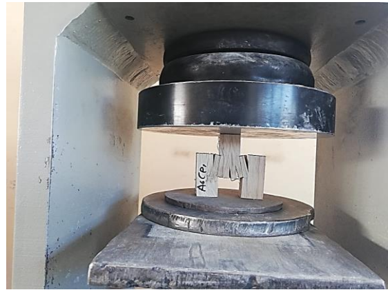
Ensayo de cizallamiento
