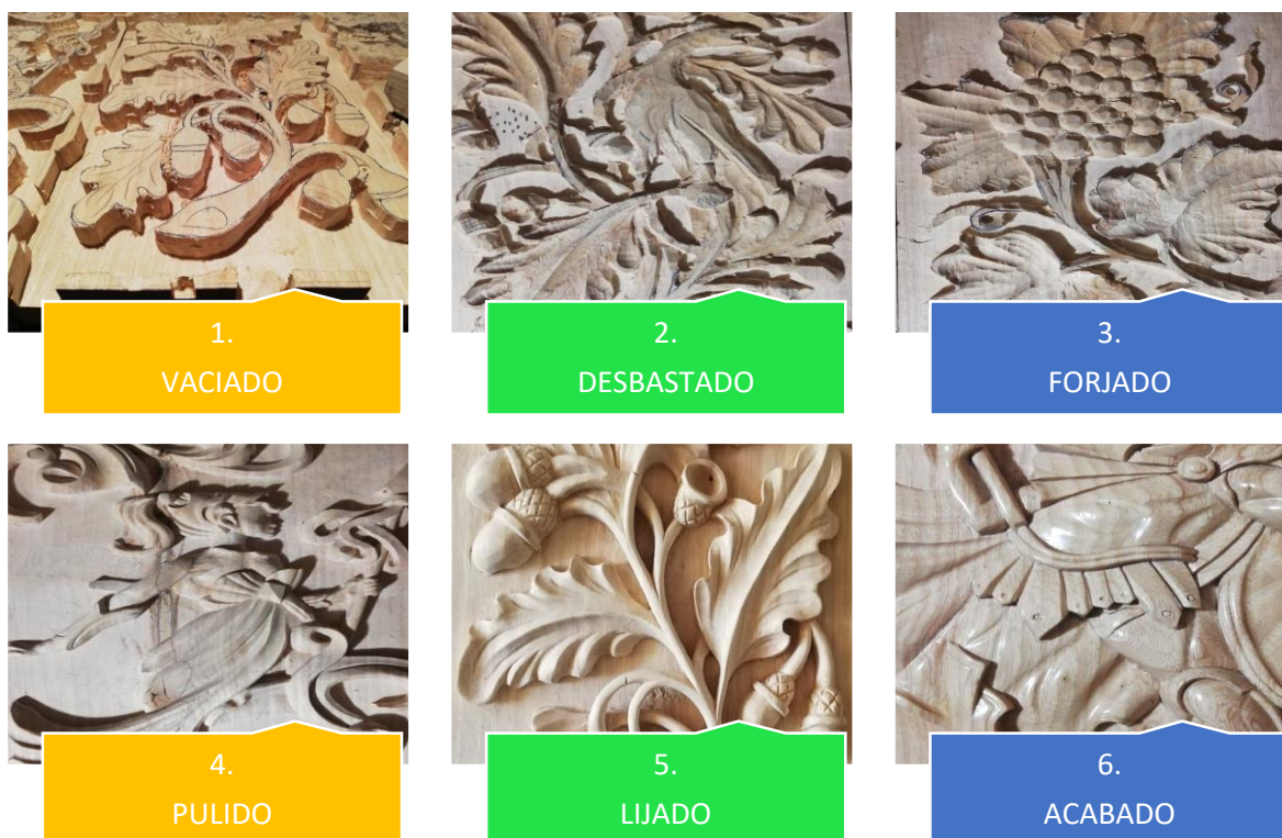
Ilustración 25. Proceso del ensayo de tallado en Fresno
