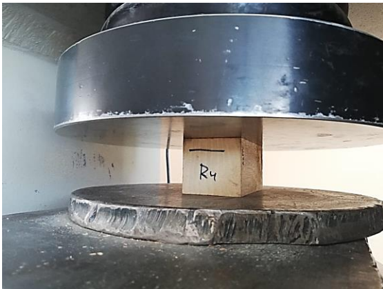
Ensayo de compresión perpendicular a la fibra
