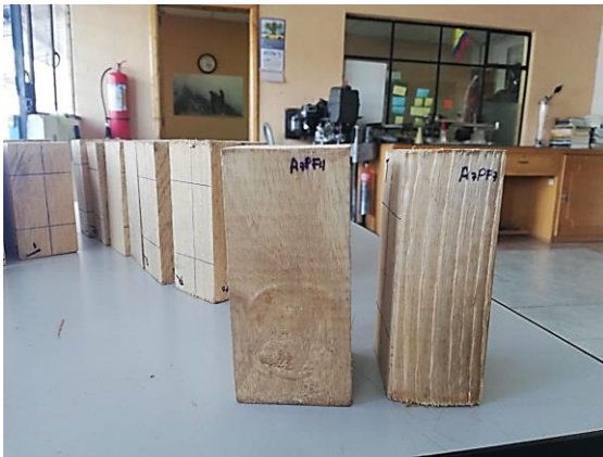
Probetas para ensayos de compresión
