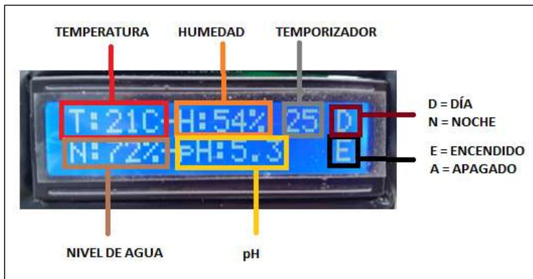
Fig. 2.16 Datos de la pantalla LCD en pruebas de funcionamiento
