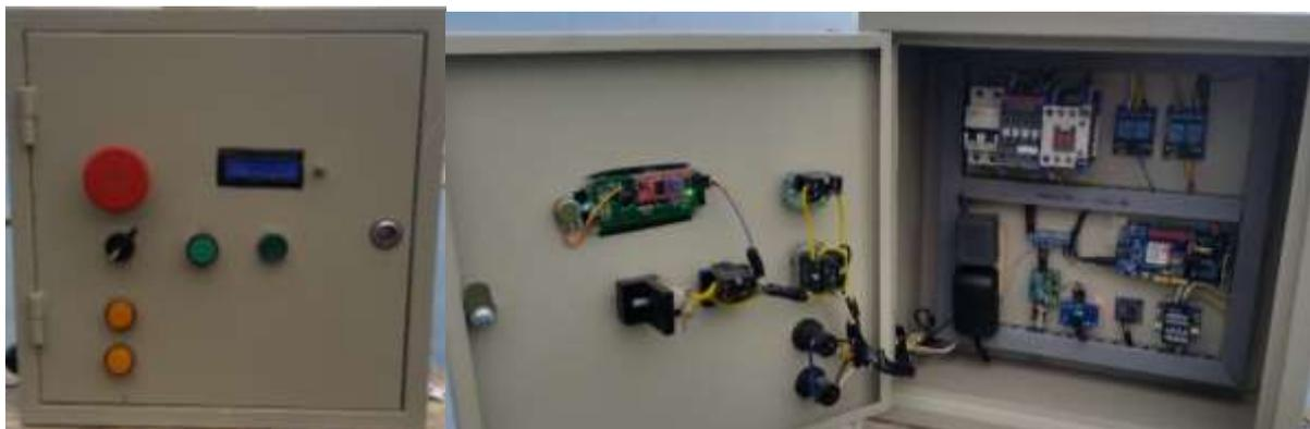
Fig. 3.4 Tablero de control finalizado
