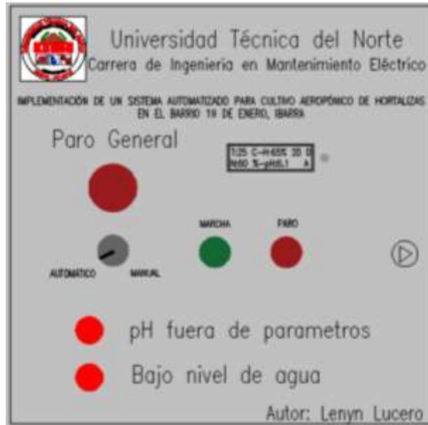
Fig. 2.11 Diagrama de distribución externa del tablero de control.
