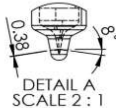
Figura 2.7 Orificios de la Tobera
