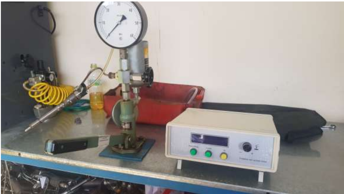
Figura AII.3 Conexión del inyector y el simulador de pulsaciones en el banco de pruebas
