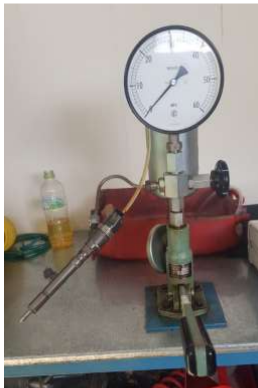
Figura AII.2 Colocación del inyector en el banco de pruebas
