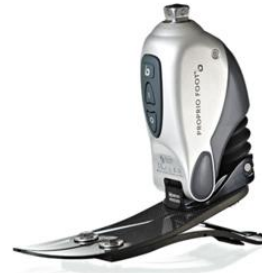
(b) Pie Proprio Foot, representando a una prótesis con almacenamiento de energía
