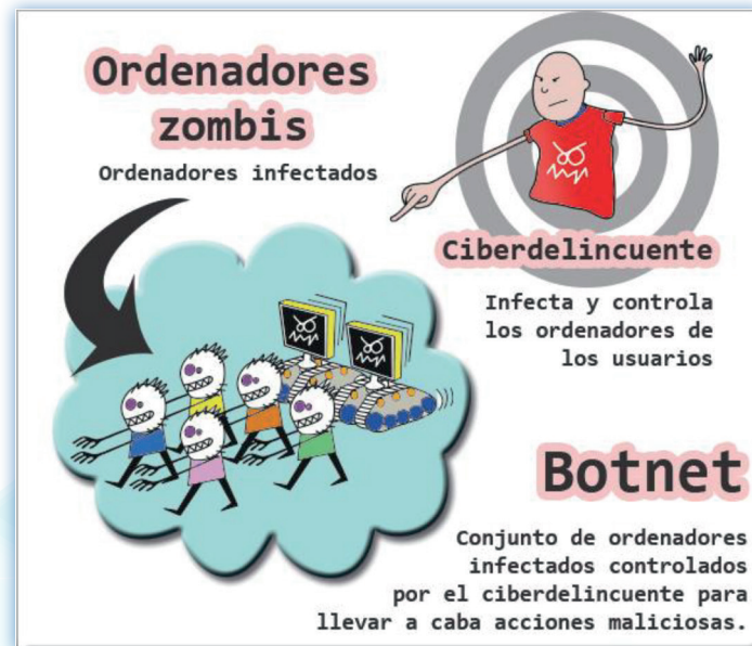
Figura 34. Robots informáticos botnets
