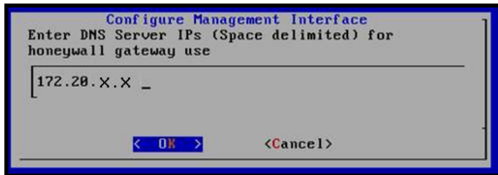
Figura B.15. Configuración de la dirección IP del Servidor DNS del Honeywall
