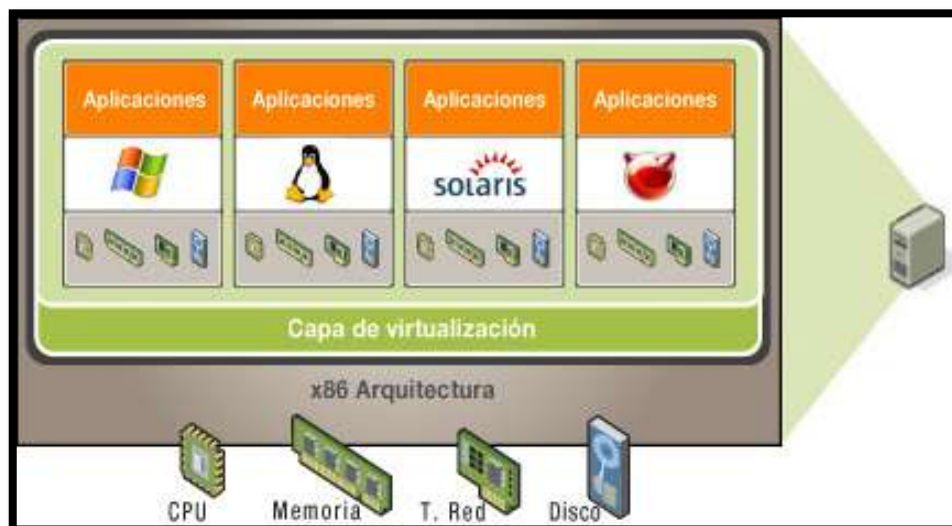
Figura 3. Virtualización de Servidores. Fuente: Virtualízate (2011). Recuperado de: http://www.virtualizate.es/virtualizacion.html
