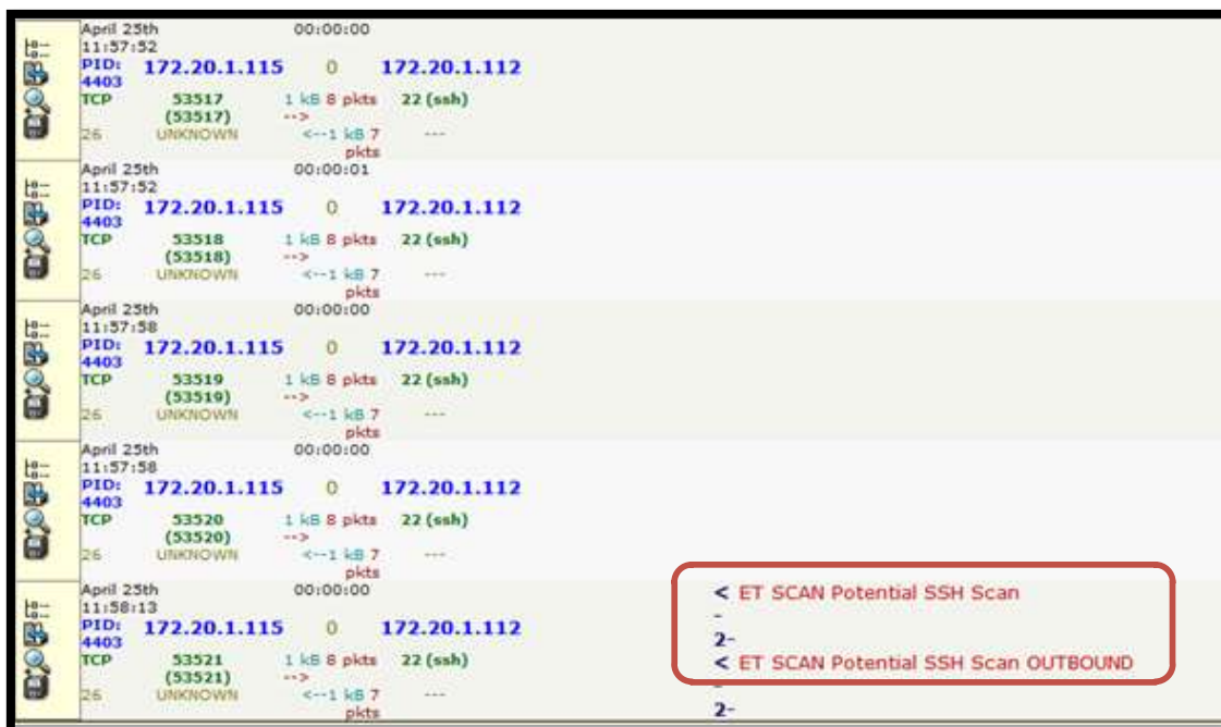
Figura 65. Alerta generada en Walleeye ante el ataque de fuerza bruta lanzado al servidor SSH del Honeypot 1
