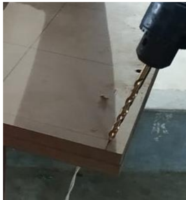
Figura 3.12. Perforación de los agujeros
