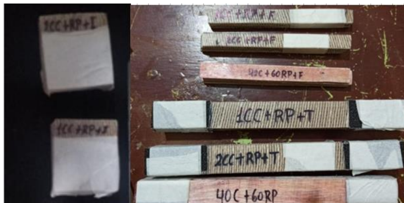
Figura 3.18. Probetas de tracción, flexión e impacto
