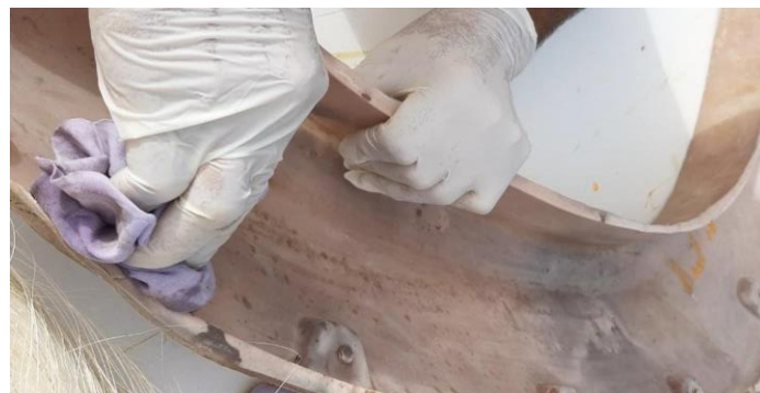
Figura 3.20. Aplicación de la cera desmoldante
