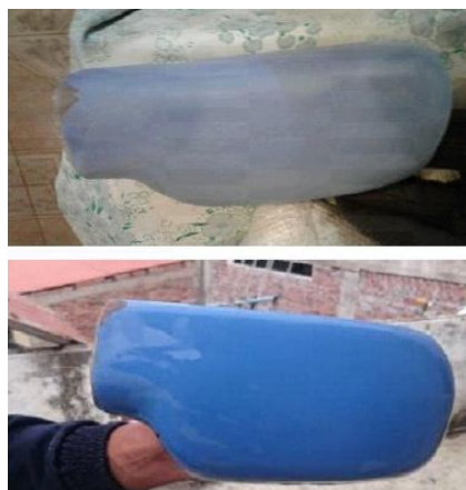
Figura 2.11. Acabado superficial del retrovisor (Loza Chávez & Pila Espinosa, 2017, pág. 53)
