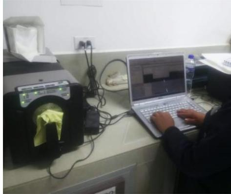
*Anexo10.* Medición de muestras en el espectrofotómetro
