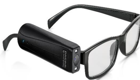
Figura 2.9 Dispositivo implementado en lentes OrCam My eye [29]
