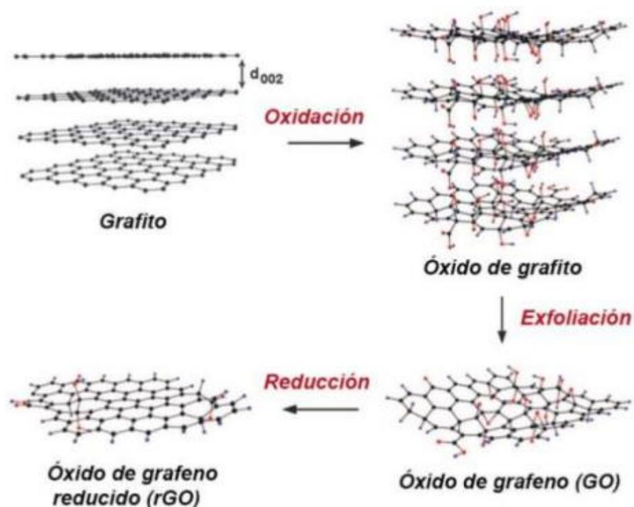
Figura 4. Proceso de obtención desde el grafito hasta el óxido de grafeno reducido (rGO)
