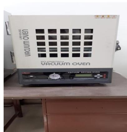
**Anexo 14.** Proceso de secado probetas
