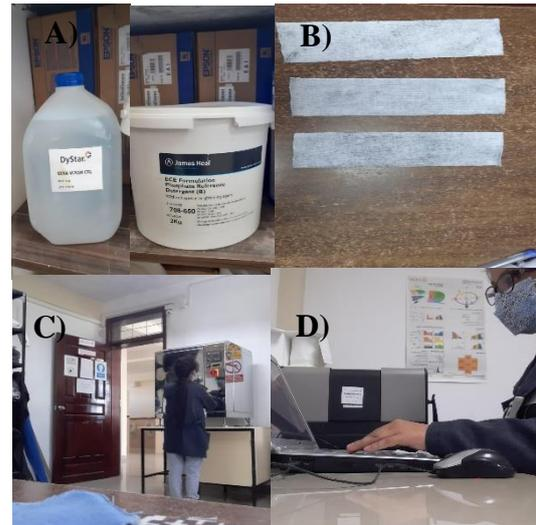
**Anexo 16.** Prueba de solidez al lavado: **A)** Izquierda detergente líquido, derecha detergente en polvo, **B)** Probetas de 5cm x 15cm, ingreso de vasos al equipo autoclave, **D)** Análisis de las probetas bajo la escala de grises.
