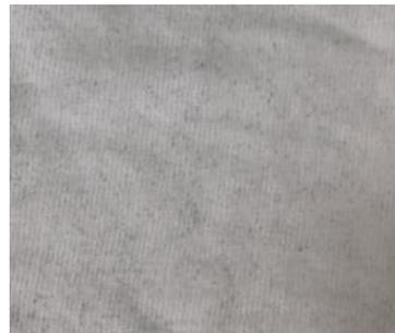
*Figura 12.* Aplicación del 1% de grafeno, muestra 4
