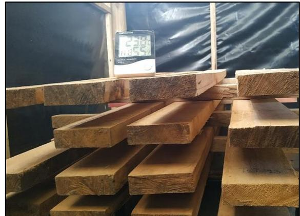
*Instalación y toma de datos con termómetro higrómetro en método de "cámara solar"*
