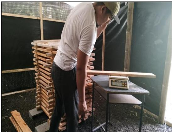
*Utilización de balanza digital para toma de Pp*
