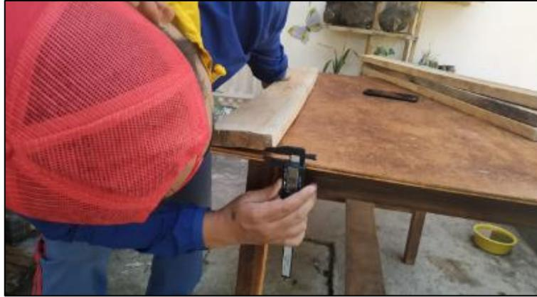
*Clasificación de defectos y toma de datos “intensidad de defectos”, empleando pie de rey digital*
