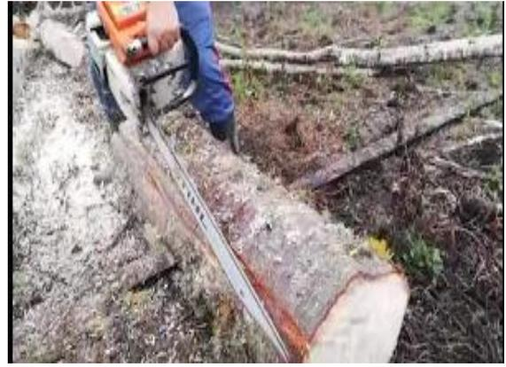
*Extracción de bloques de madera, para facilitar su transporte y posterior extracción de tablillas.*
