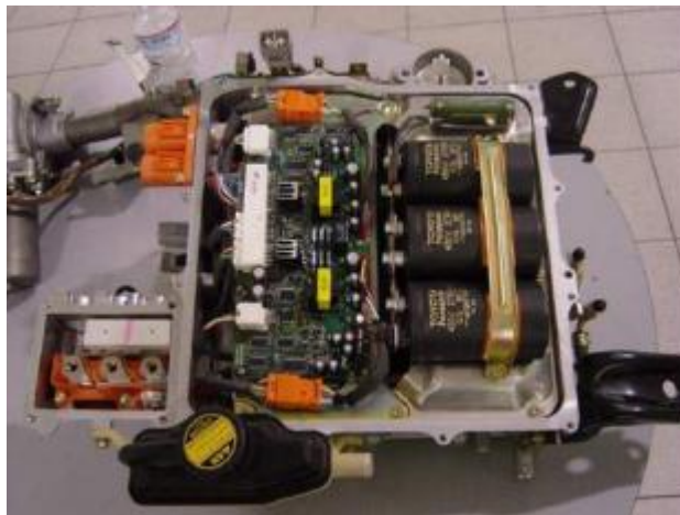
Figura 1.11 Componentes de un inversor (Automotive Technical Projects, S. L., 2012, pág. 80)
