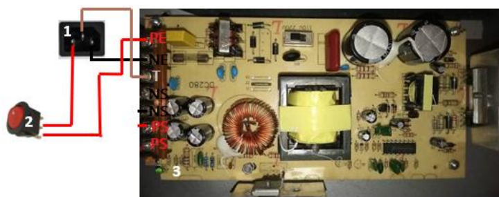
Figura 2.5 Conexiones de energización de la fuente conmutada
