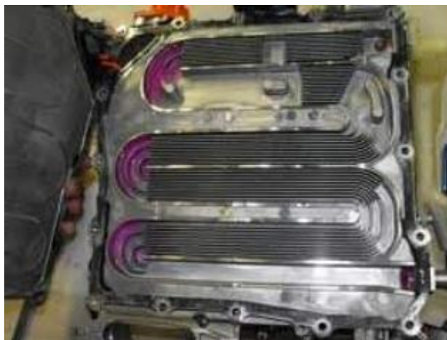
Figura 1.12 Sistema de refrigeración del inversor (Automotive Technical Projects, S. L., 2012, pág. 84)
