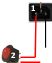
Figura 2.4 Componentes de energización principal
