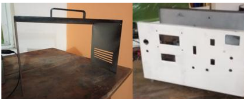
Figura 2.12 Construcción de la carcasa
