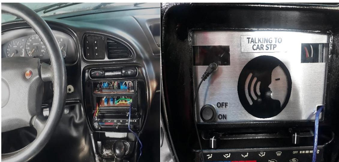
**Figura 3.21** Módulo electrónico de control instalado en el vehículo
