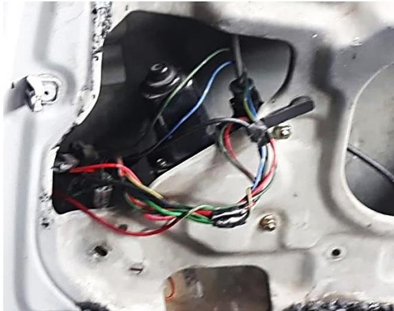
**Figura 3.24** Motor de elevallunas puerta trasera derecha
