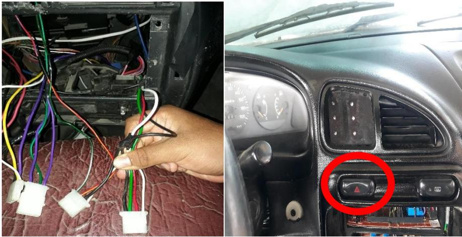
**Figura 3.28** Cableado y botón de luces de parqueo
