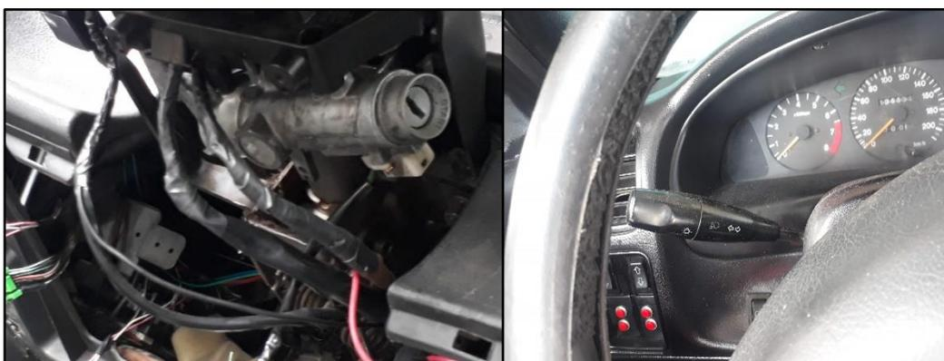
**Figura 3.26** Cableado y mando de luces en el volante del vehículo
