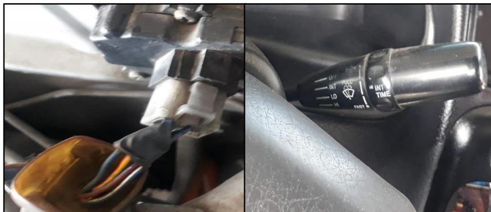
**Figura 3.30** Cableado y mando del sistema limpiaparabrisas
