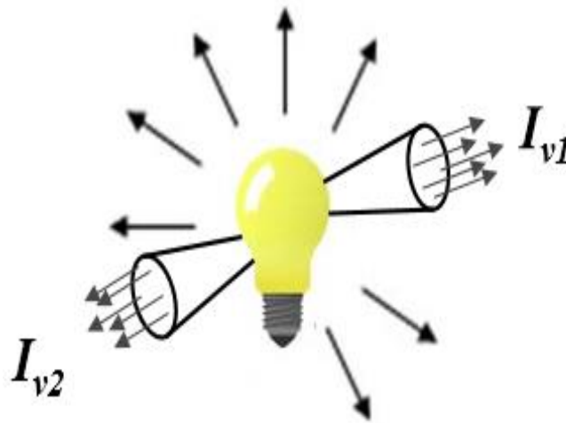
Fig. 7. Intensidad luminosa Fuente: (Isr, 2017b)
