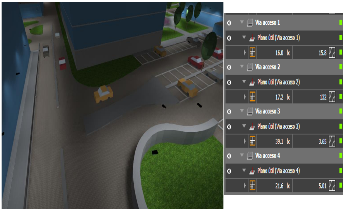
Fig. 24. Simulación de iluminación de vías de acceso de la UTN Fuente: (El Autor, 2020)
