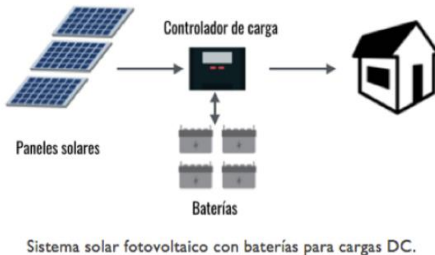
Fig. 12. Sistema solar fotovoltaico aislado a la red Fuente: (SunSupply, 2017)
