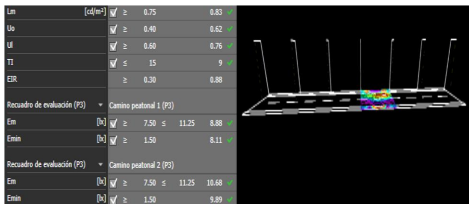
Fig. 28 Niveles de iluminación y ubicación de postes y luminarias Fuente: Autor.
