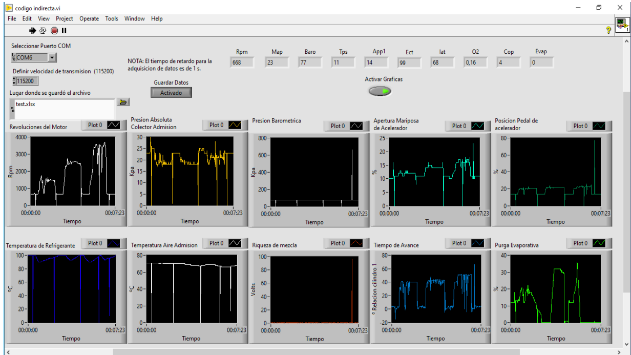
Anexo III.1 Panel frontal de registrador de datos en prueba de vehículo Hyundai Tucson
