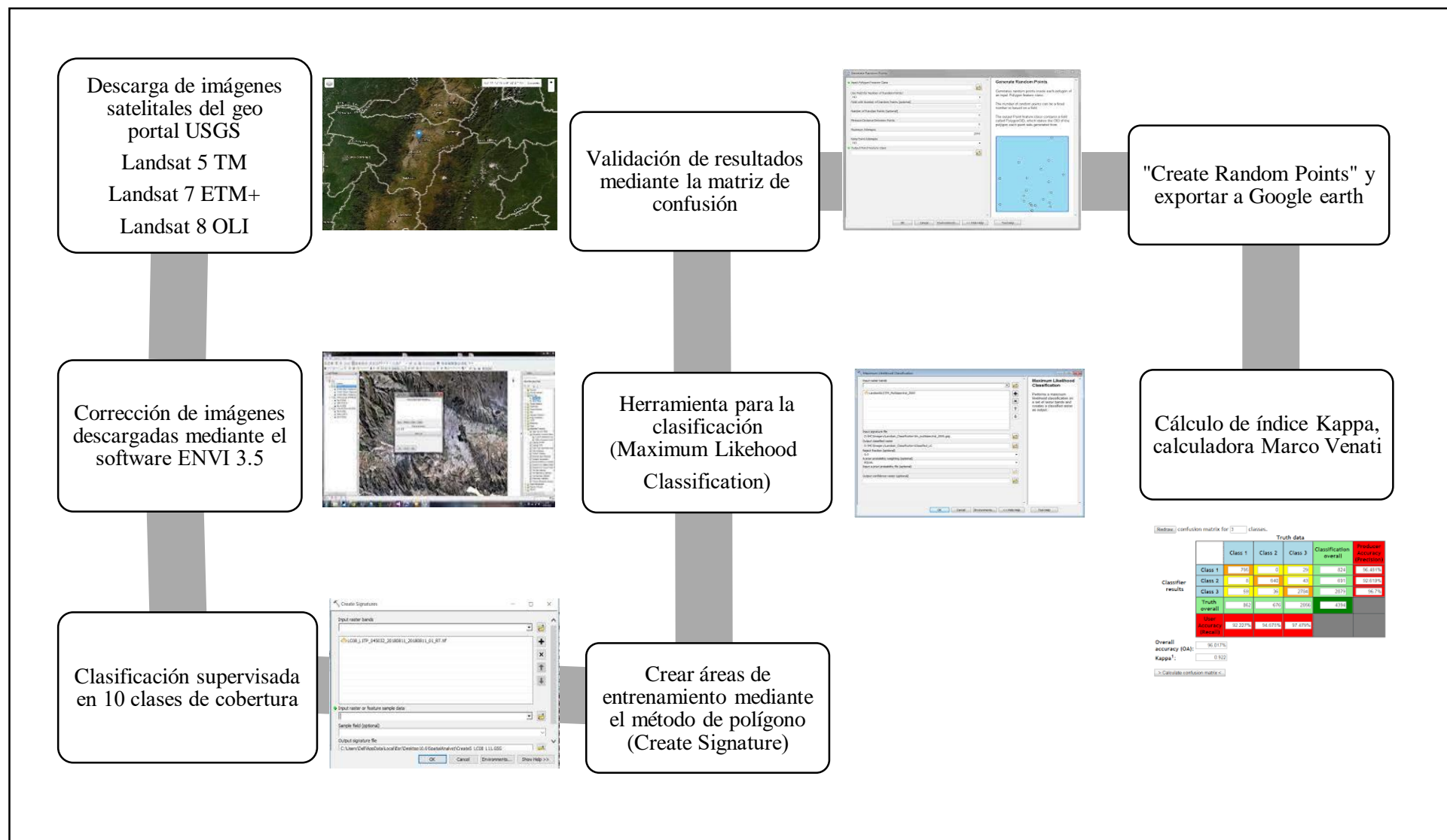
Figura 4. Flujoograma del proceso de corrección de imágenes, clasificación supervisada y validación.
