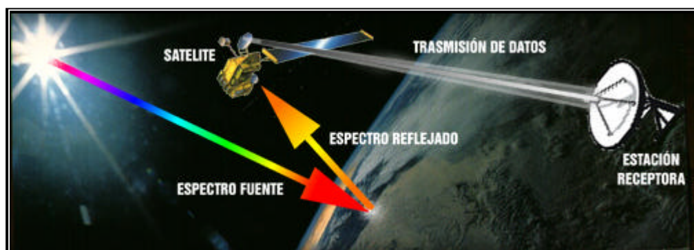
Figura 5.1. Esquema operativo de un satélite de observación
