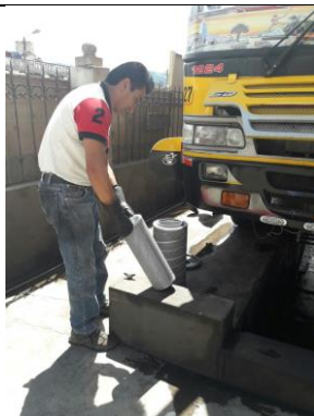
LIMPIEZA DE FILTROS
