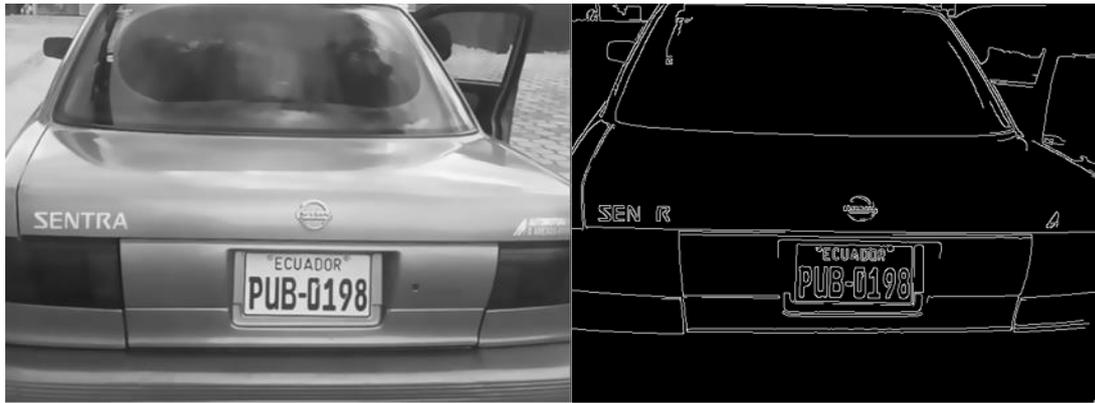
*Ilustración 12: Aplicación de filtros en la imagen del vehículo*
