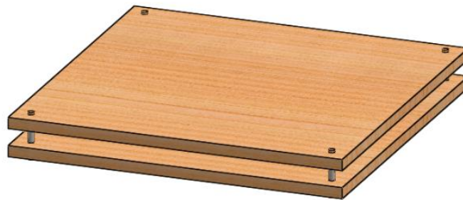
Fig. 20: Diseño de las capas del prototipo de Baldosa piezoeléctrica (SolidWorks) Fuente: Autor
