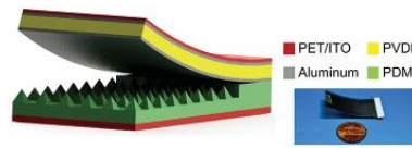
Fig. 12: Diseño un nanogenerador híbrido "r-shaped" Fuente: (Fan, Tang , & Wang, 2016)
