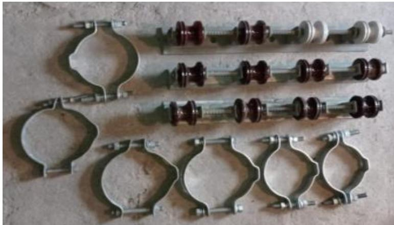
**Figura 2.20** Estructura de Cuatro Vías Retención
