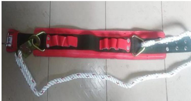
**Figura 2.23** Cinturón de Seguridad
