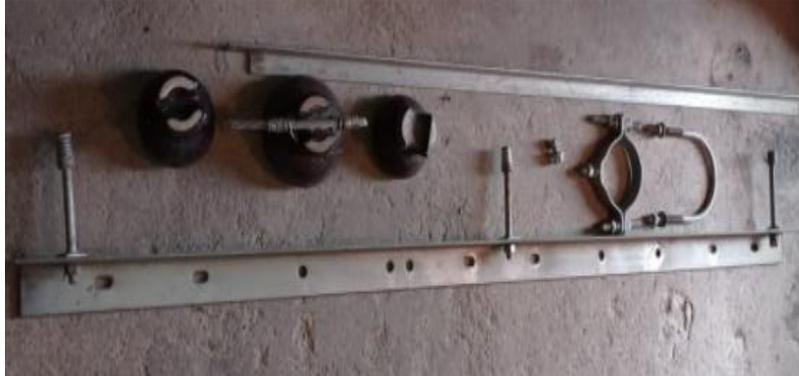
**Figura 2.19** Estructura Trifásica Volada Pasante
