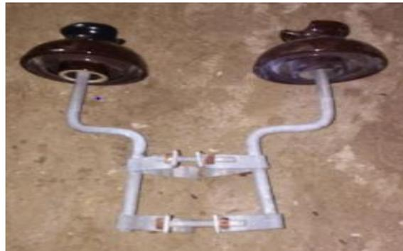
**Figura 2.21** Estructura Monofásica Centrada Angular
