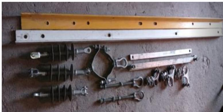
**Figura 2.18** Estructura Trifásica Centrada Retenida
