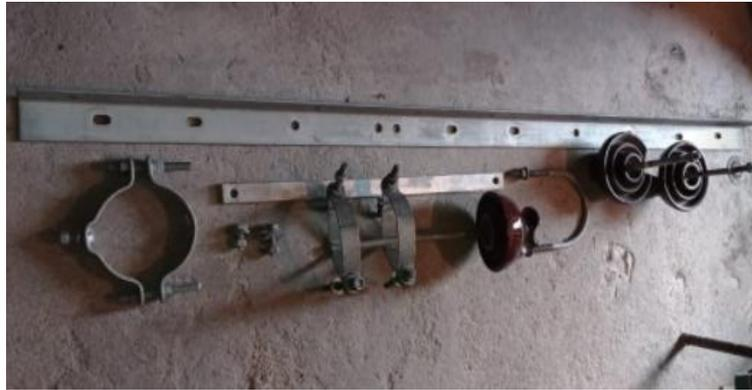
**Figura 2.17** Estructura Trifásica Centrada Pasante
