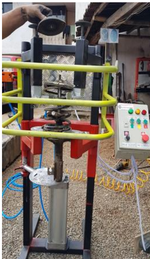
Figura 3.19 Colocación correcta del resorte en el opresor neumático Fuente: (Autores)
