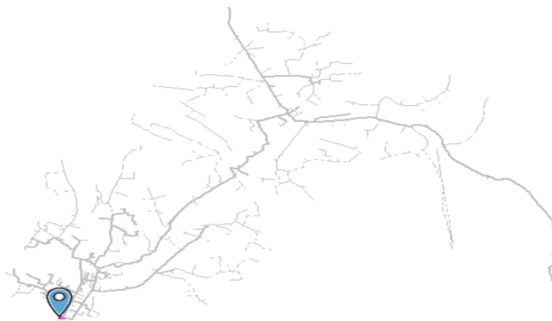
Fig. 28 Tramo de alimentador 6 donde instalar capacitores Fuente: EMELNORTE
