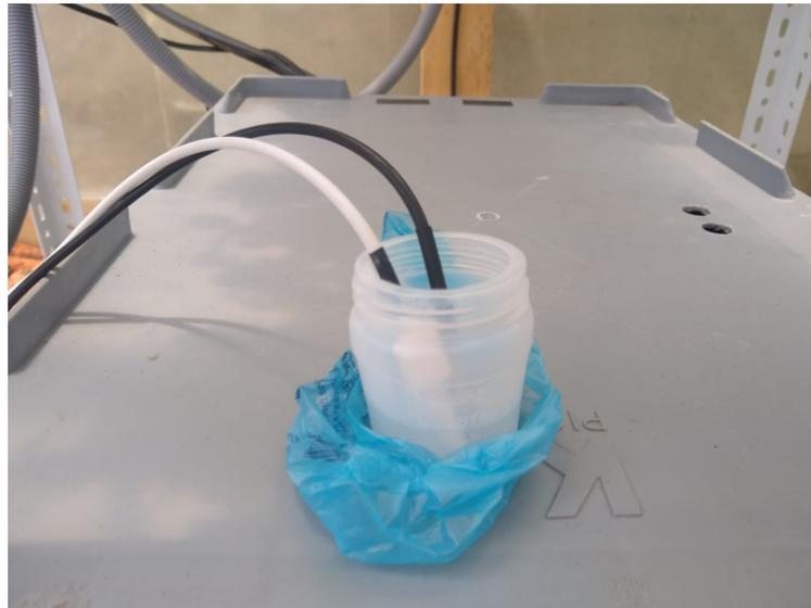
Figura 3.43: Calibración de constante de celda de conductividad.
