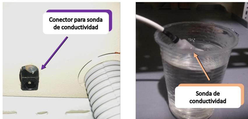
Figura 3.6: Conector y sonda para la medición de conductividad.
