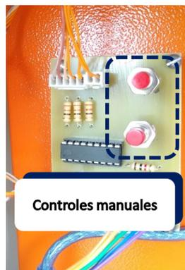
Figura 4.8: Pulsadores para el control local del sistema.
