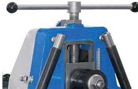
Figura 19. Máquina curvadora con ajuste manual [37].
