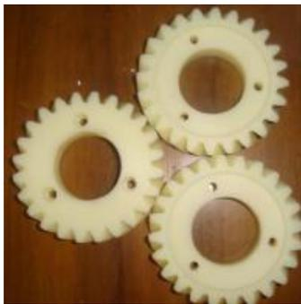
Figura 13. Rueda dentada de poliamida (PA)
