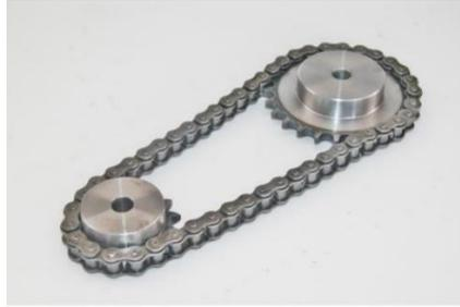
Figura 24. Sistema de transmisión por cadenas [44].
