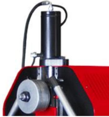
Figura 20. Máquina curvadora con ajuste neumático automático [38].
