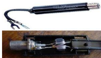
Fig. 9. Transformador de impedancia.
