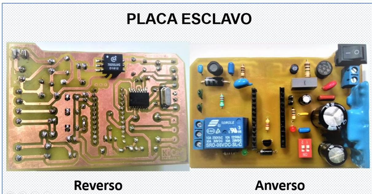
Fig. 24 Placa electrónica esclavo y PLC de acople a la red eléctrica
