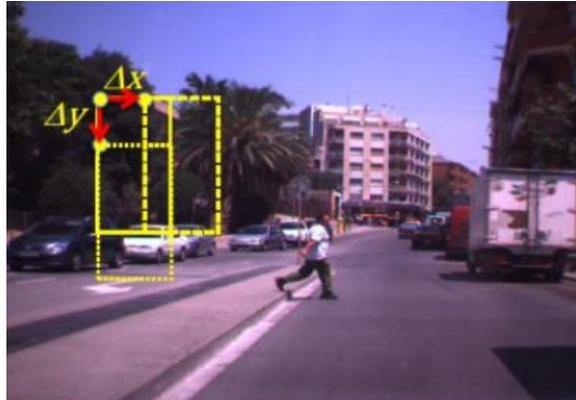
Figura 1.3: Representación del desplazamiento de una ventana deslizante [16].
