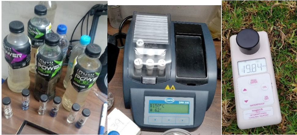
Figura 17.- Muestras para variables exsitu, bloque reactor para análisis de DQO, y turbidímetro para medir la turbiedad.
