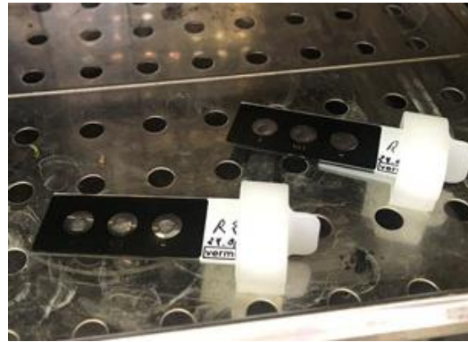
Fotografía 6 Secado del portaobjeto Nitri-VIT en posición horizontal durante 15 a 30 minutos a 46°C
