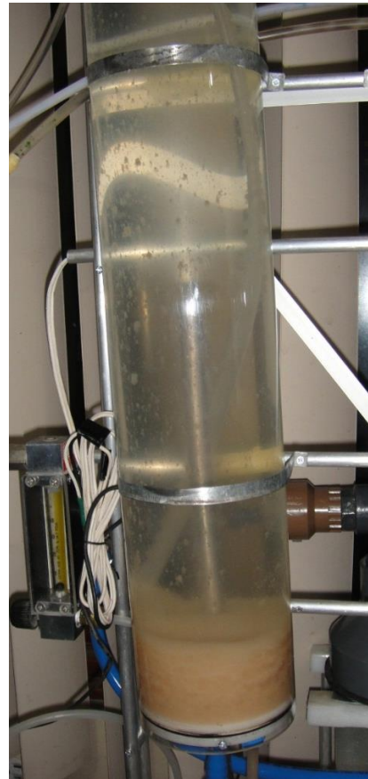
b) Reactor R2 con aireación
