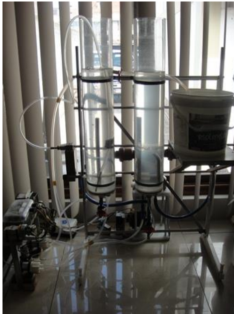
Fotografía 1 Prueba de estanqueidad de los reactores con agua limpia
