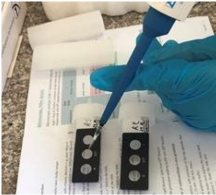
Fotografía 5 Colocación muestra diluida en alcohol absoluto relación 1:1 en el portaobjeto Nitri-VIT
