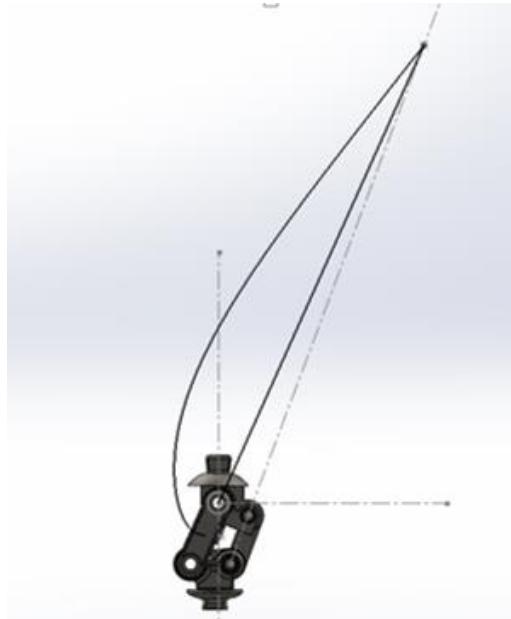
Figura 31. Trazo del CIR de la prótesis de 4 barras.
