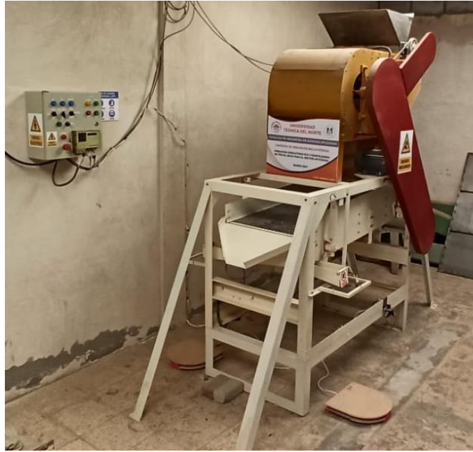
Figura 64. Cribadora semiautomática y dosificadora de fréjol seco para el sector artesanal.
