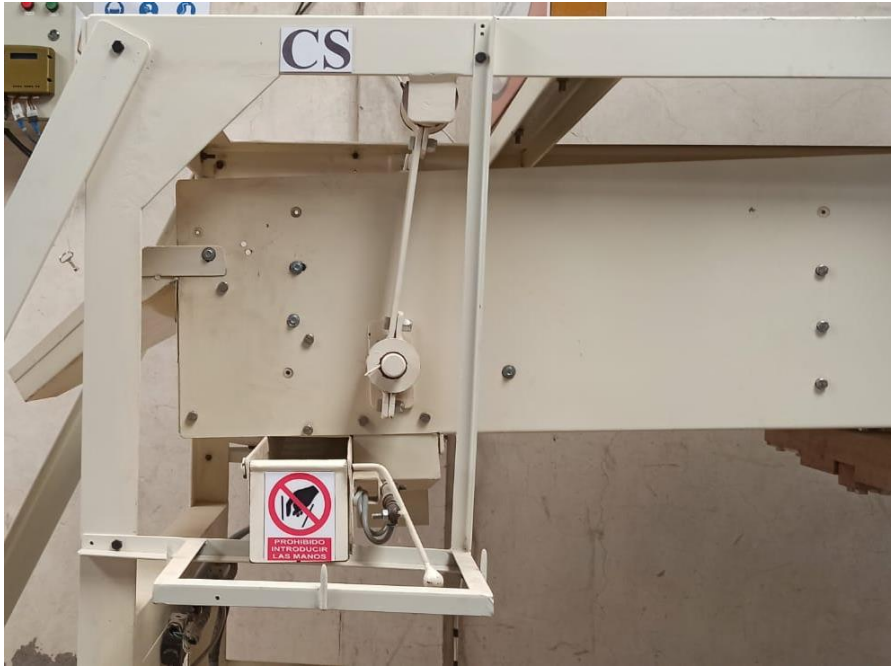
Figura 68. Canaleta de la segunda criba clasificadora implementado el sistema de dosificación automática.
