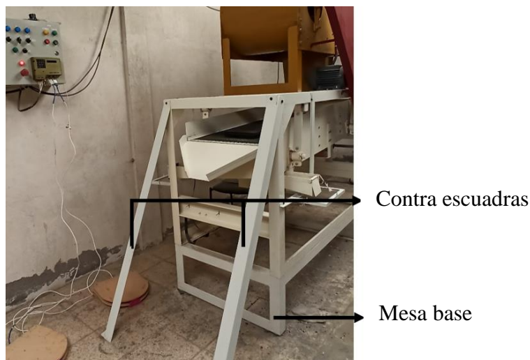
Figura 59. Mejoras en la estructura de la máquina.
