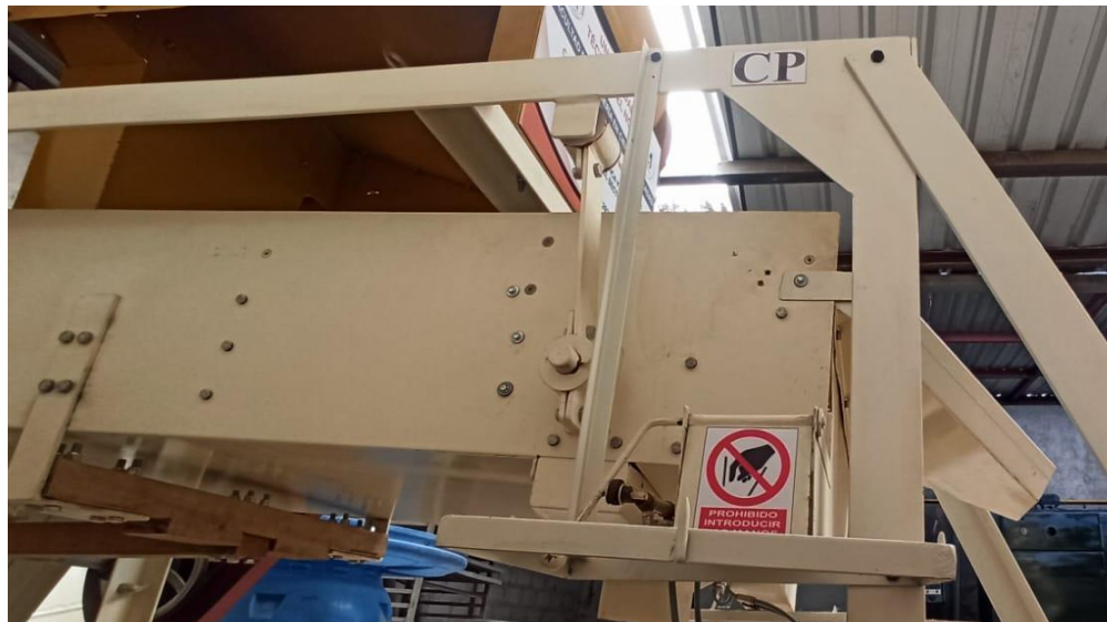
Figura 67. Canaleta de la primera criba clasificadora implementado el sistema de dosificación automática.
