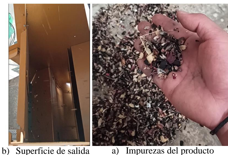
Figura 44. Eliminación de impurezas del producto por medio del ventilador.
