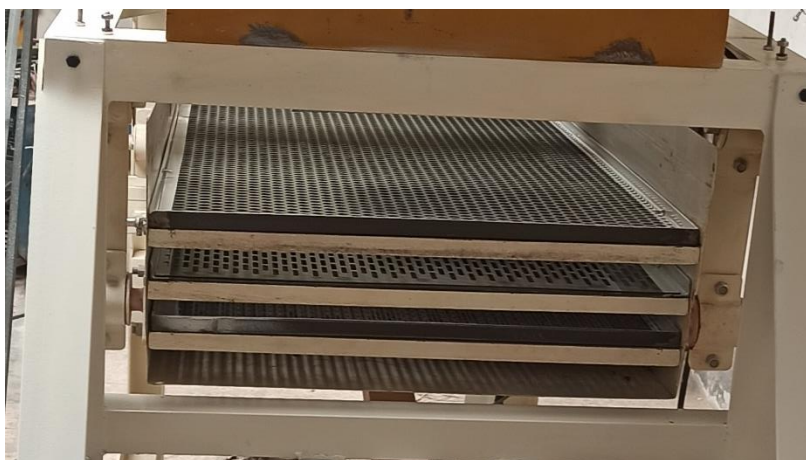
Figura 57. Parte posterior del bastidor para el intercambio de cribas.
