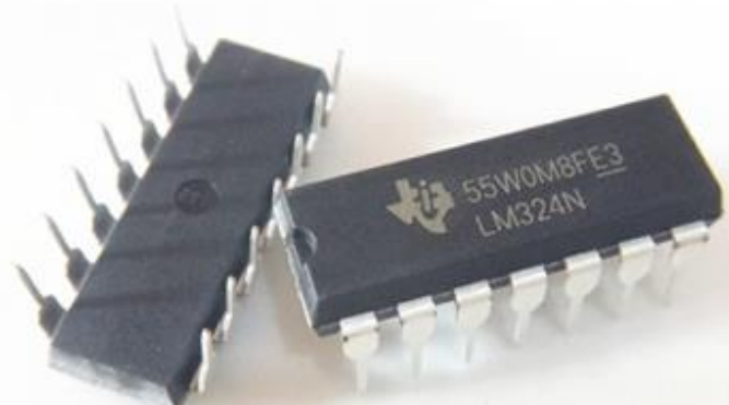
Fig.2. 6. Amplificadores operacionales cuádruple
