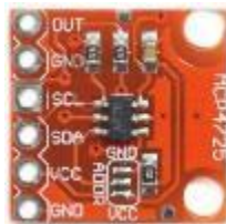
Fig.2. 9. módulo DAC MCP4725 Fuente: (naylampmechatronics, 2021)
