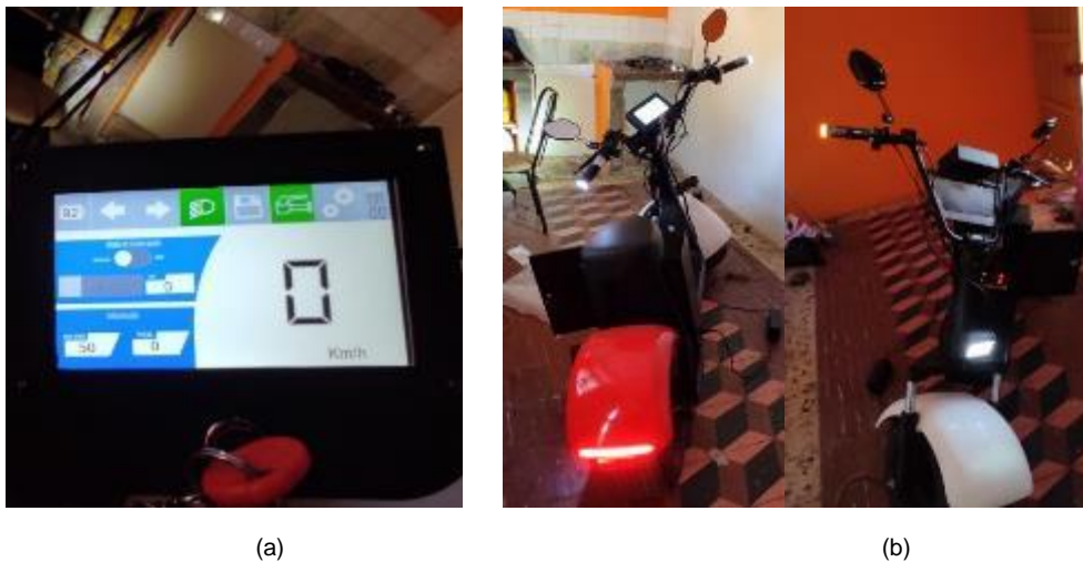
Fig.3. 9. (a)Funcionamiento del HMI, (b) Luces delanteras y frenos encendidos
