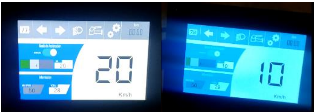
Fig.3. 11. Velocidad de referencia y velocidad alcanzada por el scooter 20 y 10 km/h, respectivamente
