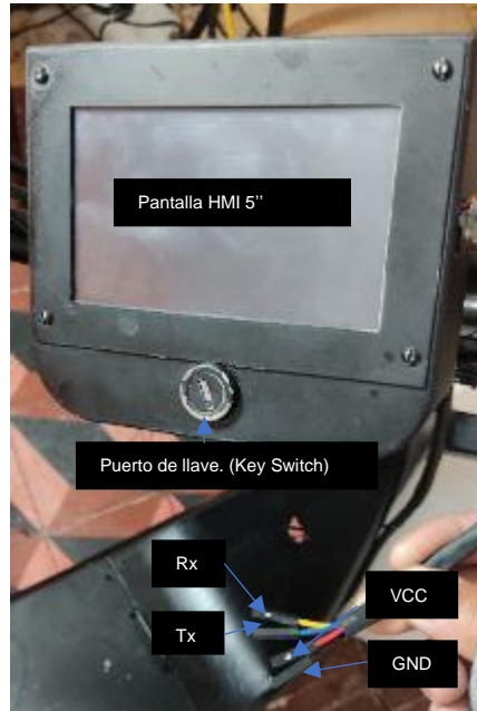
Fig.3. 3 Terminales de conexión de la pantalla touch
