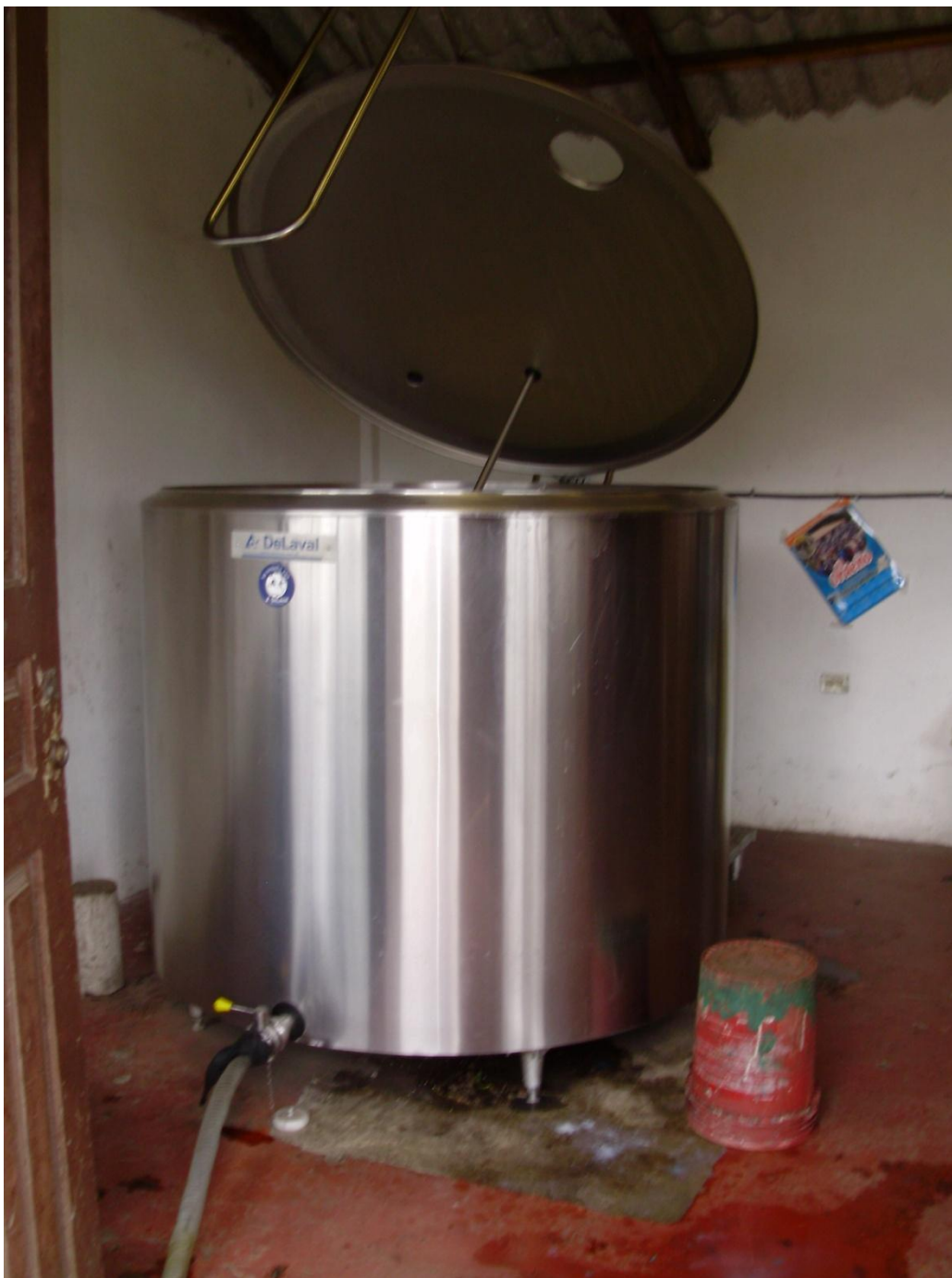
Foto 7. Tanque enfriador donde se acopia la leche
