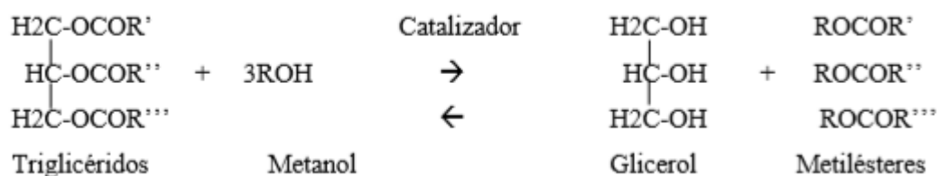
Figura 1.10 Reacción química aceite vegetal con metanol (Cárdenas, 2014, pág. 23)
