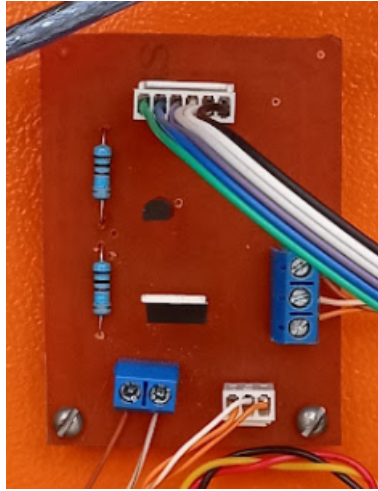
Figura 3.7: Tarjeta encargada de controlar la bomba reguladora de pH.
