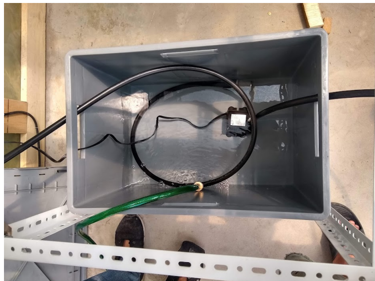
Figura 3.5: Depósito y bomba de solución nutritiva.
