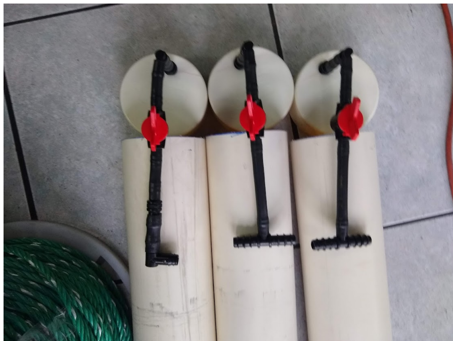
Figura 4.6: Construcción del sistema de distribución de solución nutritiva.
