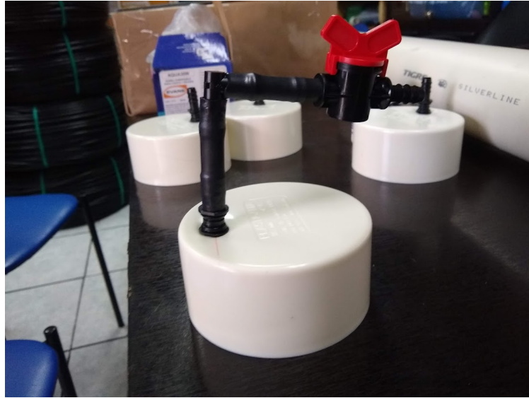
Figura 4.7: Válvulas reguladoras del paso de solución nutritiva.
