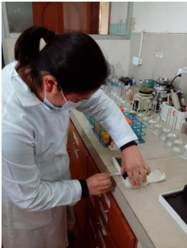
Determinación de Vitamina C en el Reflectómetro RQ flex 16970
