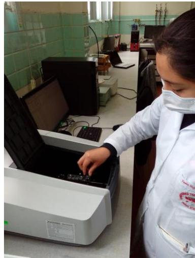
Colocación de las muestras en el espectrofotómetro UV visible
