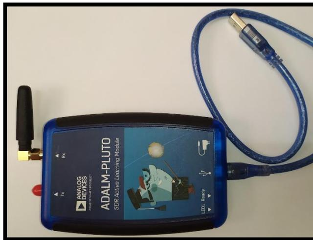
*Ilustración 27. ADALM-PLUTO y componentes conectados*
