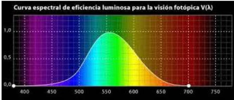
Figura 13 Curva espectral de eficiencia luminosa
