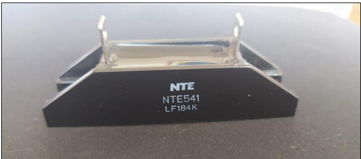
Figura 49. Rectificador de alto voltaje NTE 541 vista frontal.
