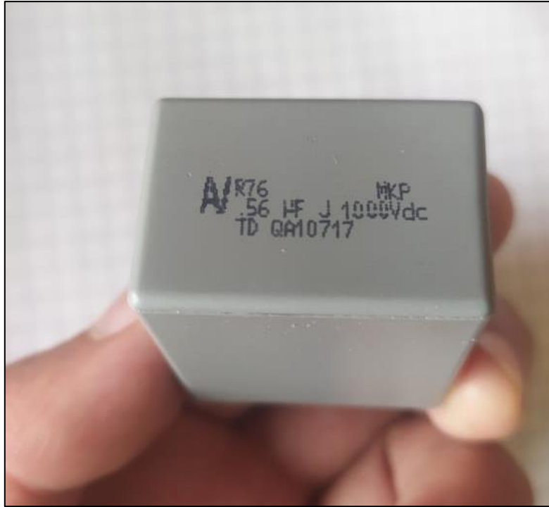
Figura 45. Capacitor Marca AJR76 ( 0.56 \mu F ) 1000V DC vista superior Fuente: Yazan Basantes Bryan Omar (2021)
