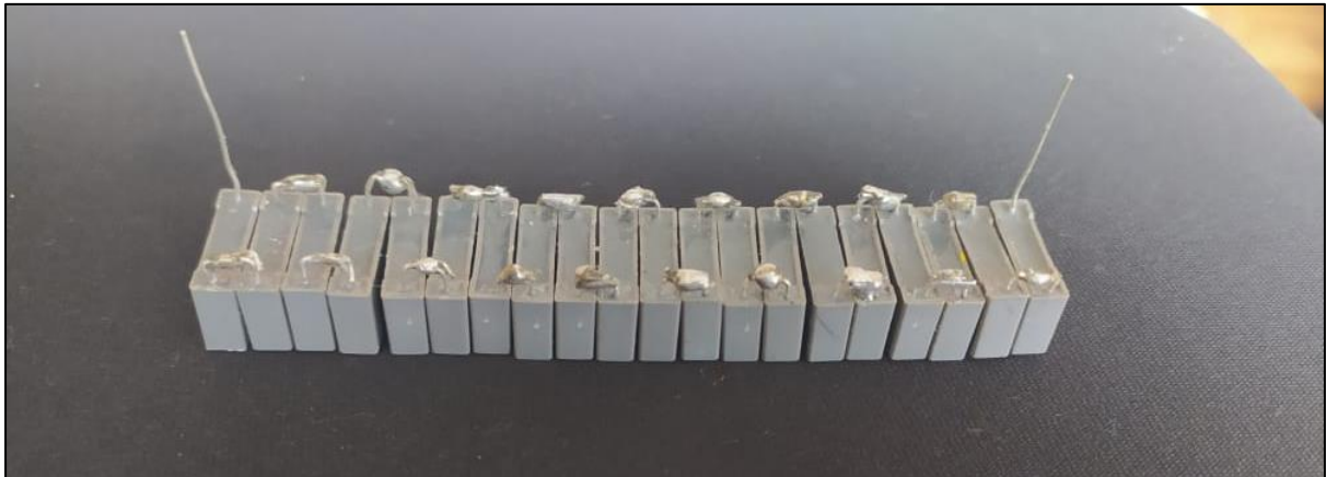
Figura 48. Capacitores Marca jb473K (0.046 \mu F ) en serie. Fuente: Yazan Basantes Bryan Omar (2021)
