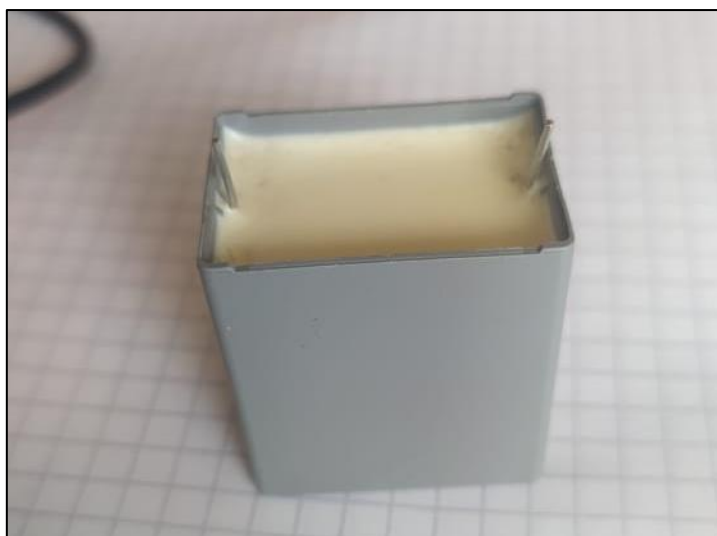
Figura 16. Capacitor Marca AjR76 (0.56 \mu F ) 1000V DC vista inferior Fuente: Yazan Basantes Bryan Omar (2021)
